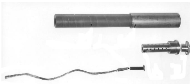
Rys. 7. Części bezpiecznika WBGN opracowanego w Katedrze Wysokich Napięć i Aparatów Elektrycznych Politechniki Gdańskiej: 1 – rura izolacyjna komory, 2 – osłona metalowa zbiornika gazów, 3 – topik, 4 – otulina, 5 – styk górny, rurowy ułatwiający schładzanie gazów, 6 – elektroda linkowa topika [1]
