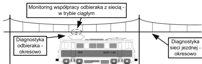
Rys. 1. Stan diagnostyki systemu odbioru prądu
