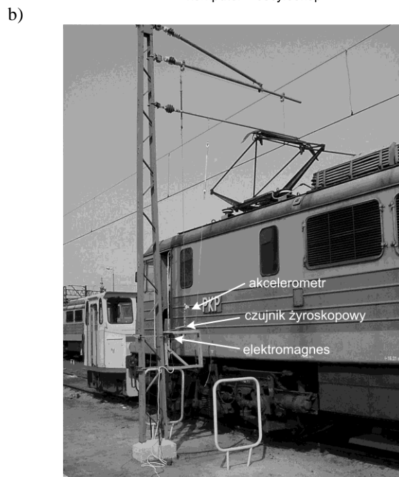
Rys. 12. Eksperymentalne terenowe stanowisko do badania stanu zawieszenia ślizgacza: a) szkic konstrukcyjny, b) widok stanowiska
