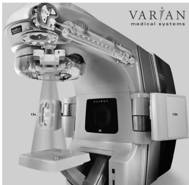
Rys. 1 Akcelerator wyposażony w opcję radioterapii wspomaganej obrazowo: 1- działo elektronowe, 2 – przełącznik energii, 3 – linia przyspieszająca, 4 – elektromagnes, 5 – system kontroli wiązki, 6 – geometryczne źródło promieniowania, 7 – tarcza filtrów, 8 – komory jonizacyjne, 9 – asymetryczne szczęki, 10 – kolimator, 11 – portal (matryca detektorów), 12a –lampa rentgenowska, 12b – portal
