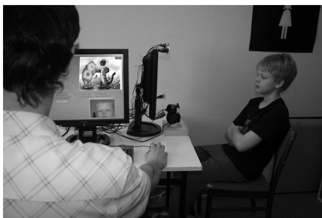
Rys. 4. Stanowisko badawcze do badania stopnia koncentracji uwagi
