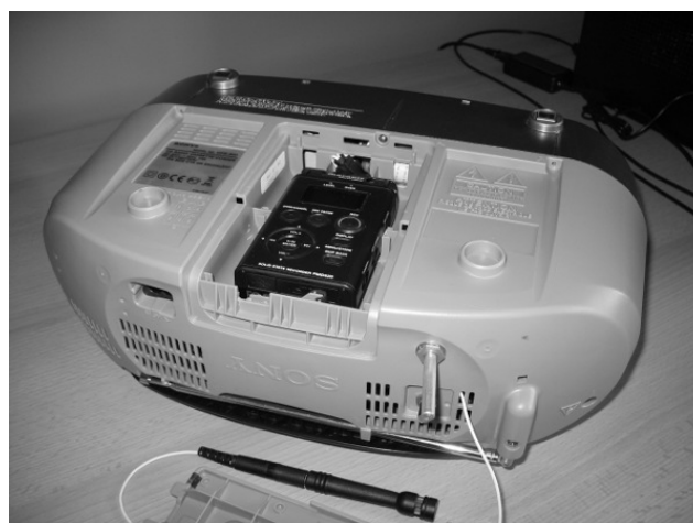
Rys. 3. Zestaw testowy złożony z radia, mikrorejestratora oraz wymiennych mikrofonów.
