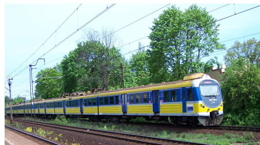
Rys. 7. Zmodernizowana elektryczna jednostka trakcyjna EN-57
