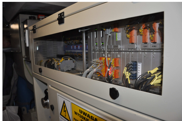
Rys. 10. Sterownik falownika napędowego lokomotywy E6ACT
