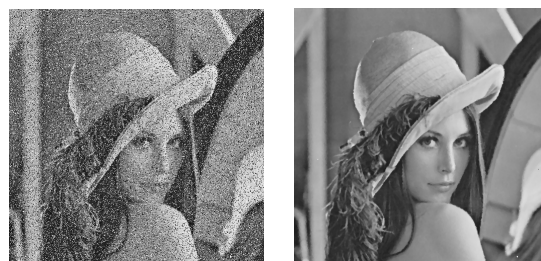
Rys. 4. Obraz „Lena” z zakłóceniem impulsowym (20% punktów) oraz wynik medianowej filtracji tego obrazu [1]
