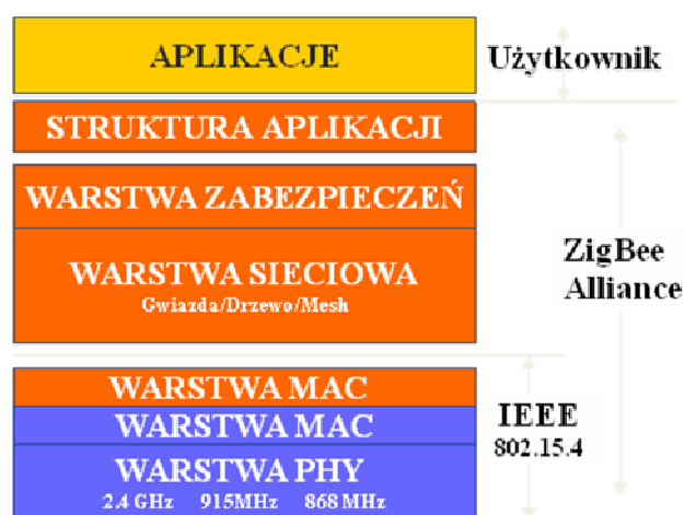
Rys. 1. Częstotliwości pracy dostępne w standardzie ZigBee
