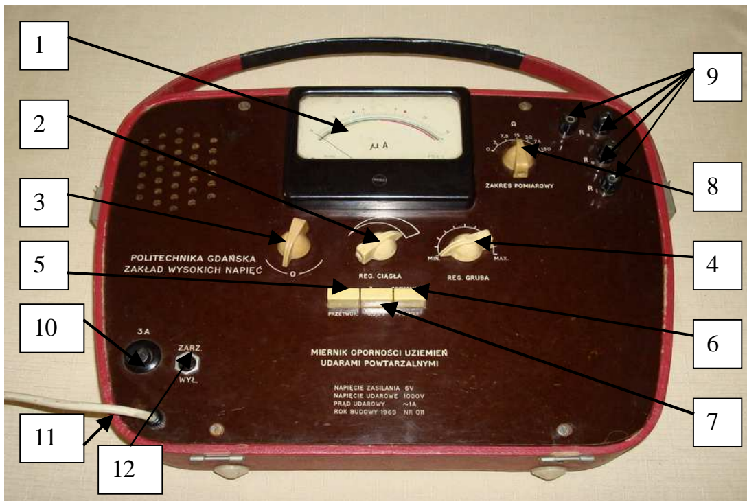
Rys. 1. Widok miernika; 1 – mikroamperomierz woltmierza elektronicznego, 2, 3, 4 – pokrętki regulacyjne woltmierza, wyłącznik przetwornicy, 6 – przełącznik czoła udaru, 7 – przełącznik woltmierza, 8 – rezystory wzorcowe, 9 – zaciski do połączenia z uziomem i sondami pomiarowymi, 10 – bezpiecznik, 11 – przewód do połączenia z akumulatorem zasilającym, 12 – załączanie żarzenia tyratronu
