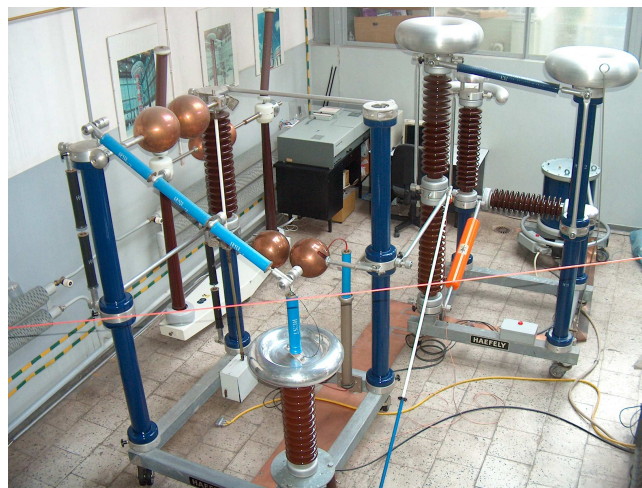
Rys. 1. System probierczy napięcia przemiennego, stałego i udarowego 400 kV
