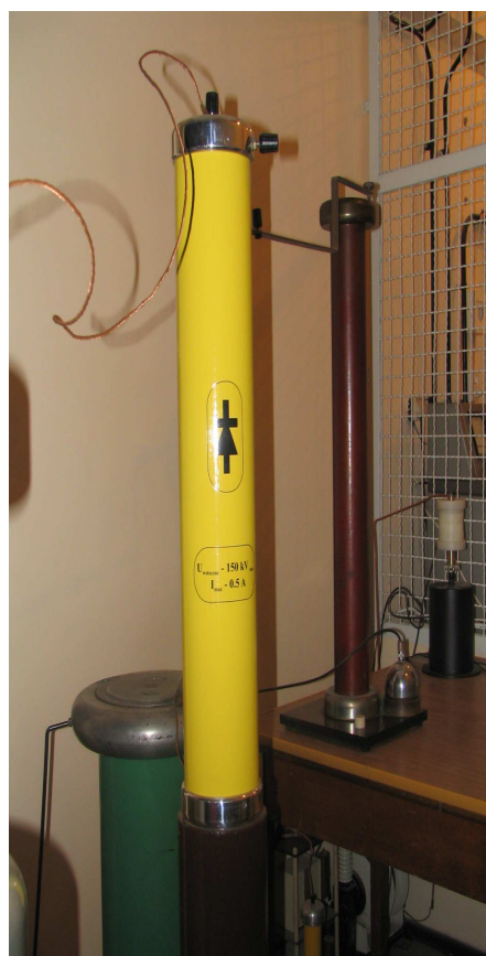
Rys. 5. Prostownik wysokiego napięcia na napięcie zwrotne do 150 kV, o średnim prądzie przewodzenia 0,5 A
