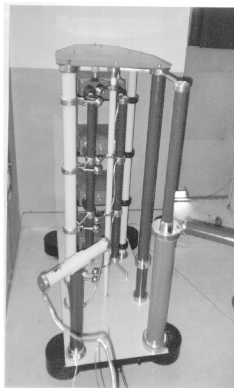
Rys. 5. Generatory udarów piorunowych i łączeniowych – zdjęcie dla GUN 300 kV
