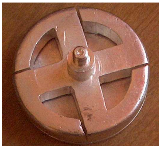
Rys. 2a Styk unipolarny (1/4 zwoju)
