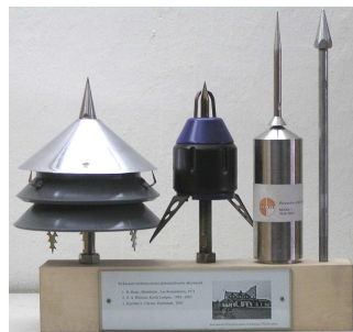
Rys. 3. Badane zwody ESE i zwód Franklina [5]
