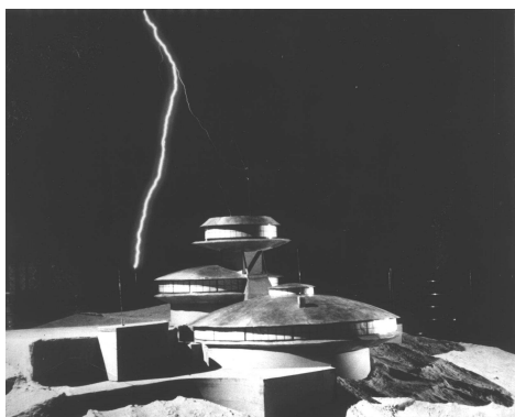
Rys. 2. Makieta obserwatorium na Śnieżce. Trafienie wyładowania w zwód na kaplicy [4]
