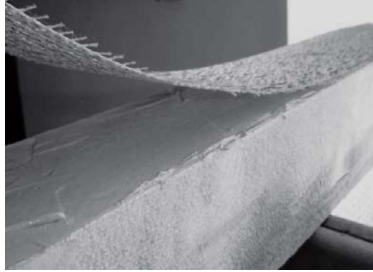
Rys. 6. Mocowanie stalowej taśmy do belki [10]
