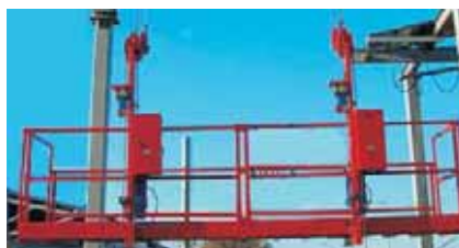
Fot. 1. Ruchomy podest zawieszony na linach Photo. 1. A cable moving work platform
