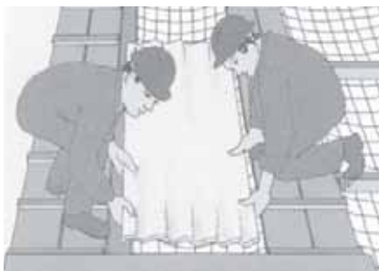
Rys. 3. Pokrywa na dachu o słabej wytrzymałości zastosowana w celu ochrony pracowników przed skutkami zawalenia się konstrukcji budowlanej
