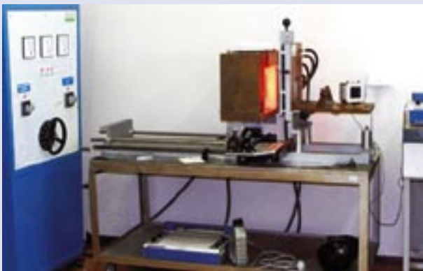
Fot. 1. Stanowisko do badania odporności odzieży ochronnej na przenikanie promieniowania cieplnego
