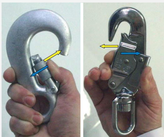
Rys. 1. Sprawdzenie samoczynnego zamykania się ramienia zatrzaśnika [3] ← niebieski – kierunek docisnięcia ramienia → żółty – kierunek samoczynnej, prawidłowej reakcji ramienia Fig. 1. Test of a self-dosing gate of a connector [3] ← niebieski – direction of the force used to open the gate → żółty – direction of a proper automatic return of the gate
