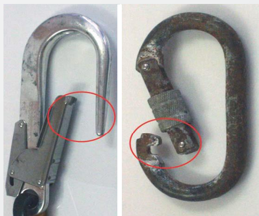
Rys. 2. Uszkodzenia zatrzaśników powodujące brak samoczynnego powrotu ramienia do pozycji zamkniętej [3] Fig. 2. Damage to connectors causing self-closing gates to malfunction [3]
