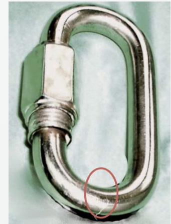
Rys. 9. Mikropełnienie korpusu zatrzaśnika ze stali nierdzewnej powstałe na skutek procesów korozyjnych [3]
