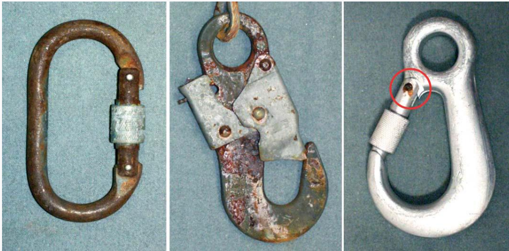
Rys. 8. Przykłady uszkodzeń korozyjnych zatrzaśników [3] Fig. 8. Examples of corroded connectors [3]
