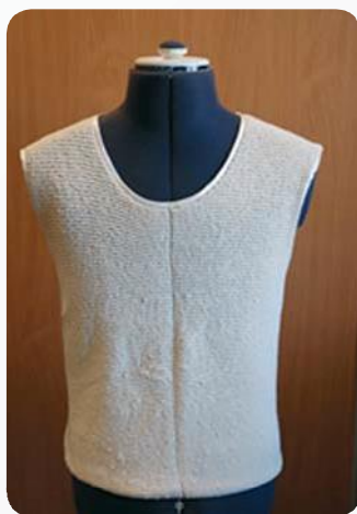
Rys. 1. Trójwarstwowa kamizelka o budowie kanałowej, wypełniona makrokapsułkami PCM (praca badawcza własna)
