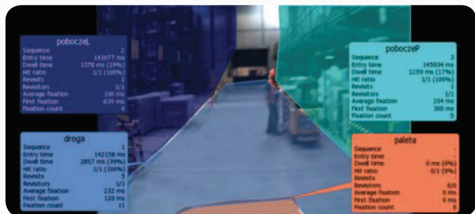
Rys. 2. Schemat obserwacji przez operatora pola widzenia przed wózkiem podczas jazdy na wprost z podziałem na obszary zainteresowania Fig. 2. Areas of Interest (AOI) when driving forward
