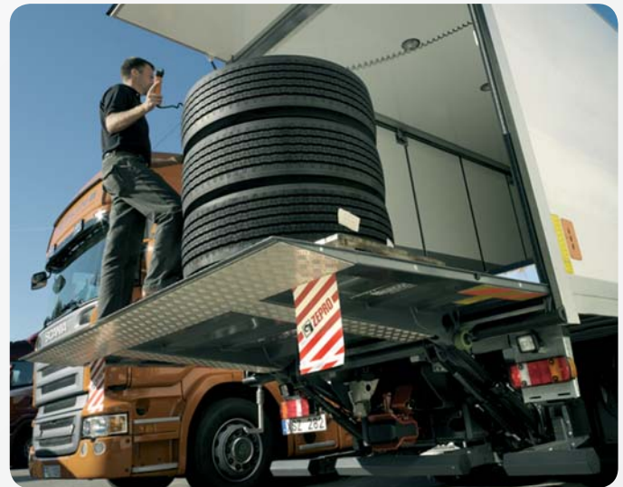
Fot. 2. Klasyczna platforma w górnym położeniu roboczym
