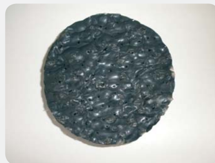
Fot. 2. Nakłucia komór powietrznych w płycie (widok z góry)
