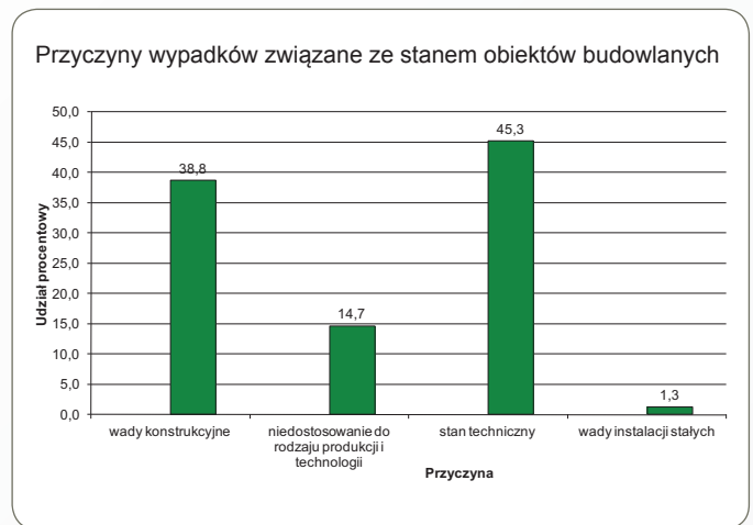
Rys. 4. Udział procentowy wypadków z przyczyn związanych ze stanem obiektów budowlanych Źródło: opracowanie własne na podstawie bazy danych KRUS za 2010 r. Fig. 4. Percentage of accidents caused the state of buildings (source: KRUS)
