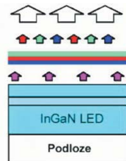
Rys. 6. Uzyskiwanie światła białego przez konwersję promieni UV w luminoforze trójwarstwowym (InGaN) [6] Fig. 6. Obtaining white by UV beam conversion in a three-level luminofores [6]
