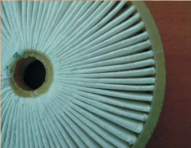
Rys. 3. Budowa wewnętrzna filtra wykonanego z plisowanej włókniny szklanej Fig. 3. Internal construction of a filter made of glass fibre
