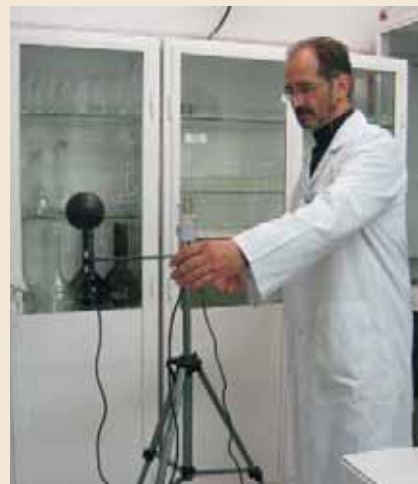
Sprawdzanie miernika mikroklimatu w Laboratorium Wojewódzkiej Stacji Sanitarno-Epidemiologicznej w Bydgoszczy
