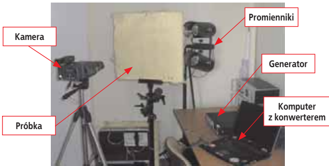
Fot. 2. Stanowisko pomiarowe do badań nieniszczących techniką termografii aktywnej
