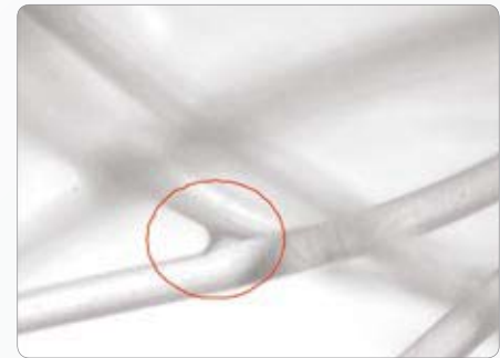
Rys. 2. Depozycja kropli aerozolu DEHS pomiędzy dwoma włóknami w procesie filtracji przy prędkości przepływu 5 cm/s i stężeniu aerozolu 10^6 cząstek/cm 3
