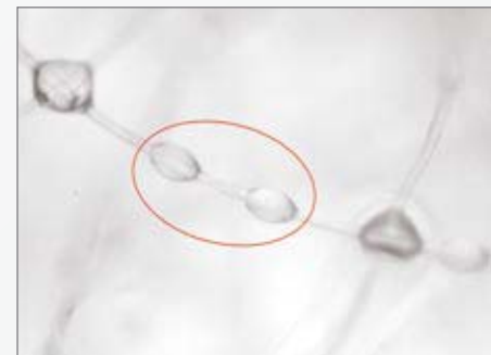
Rys. 4. Depozycja kropli aerozolu DEHS na drodze zwilżania ciała stałego przez ciecz w procesie filtracji przy prędkości przepływu 20 cm/s i stężeniu aerozolu 10^5 cząstek/cm 3
