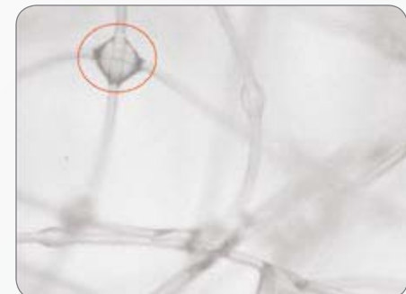
Rys. 3. Depozycja kropli aerozolu DEHS w miejscu krzyżowania się włókien w procesie filtracji przy prędkości przepływu 20 cm/s i stężeniu aerozolu 10^6 cząstek/cm 3
