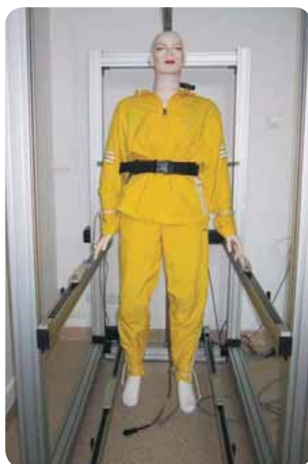
Fot. 2. Stanowisko do badania izolacyjności wynikowej Photo. 2. Test stand to measure resultant thermal insulation (dynamic, movable manikin)
