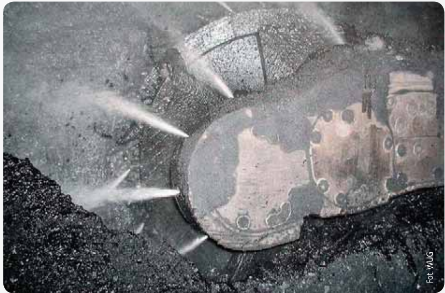
Fot. Układ zraszający kombajnu ścianowego Photo. Wall combine's spraying system
