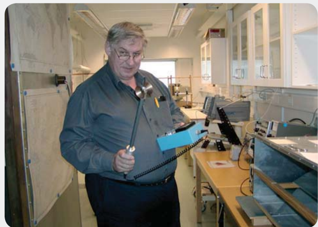
prof. Kjell Hansson Mild ze szwedzkiego Instytutu NIWL prezentuje w czasie wizyty studialnej pracowników CIOP-PIB w 2005 r. aparaturę do pomiaru pól elektromagnetycznych wielkiej częstotliwości i laboratoryjne źródło pola elektromagnetycznego, skonstruowane w latach 70. we współpracy z prof. H. Korniewiczem
