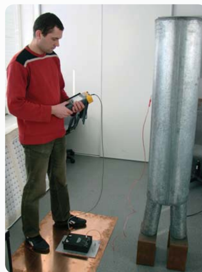
P. Zradziński w czasie badań laboratoryjnych aparatury konstruowanej na potrzeby oceny zagrożeń wynikających z rażenia prądami kontaktowymi
