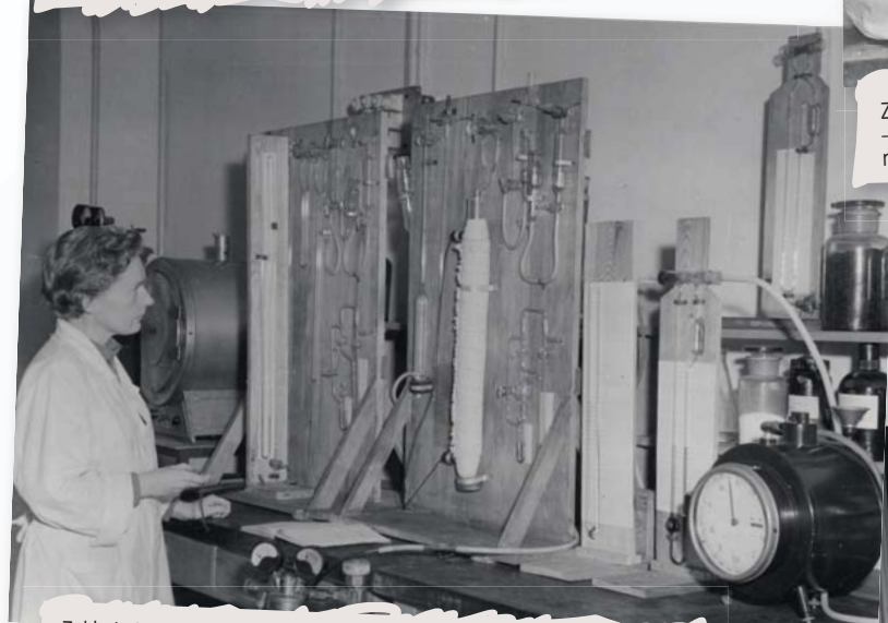
Zakład Chemii – badania aparatury do analizy ciągłej powietrza metodą chromatografii gazowej. J. Rousseau. Rok 1961
