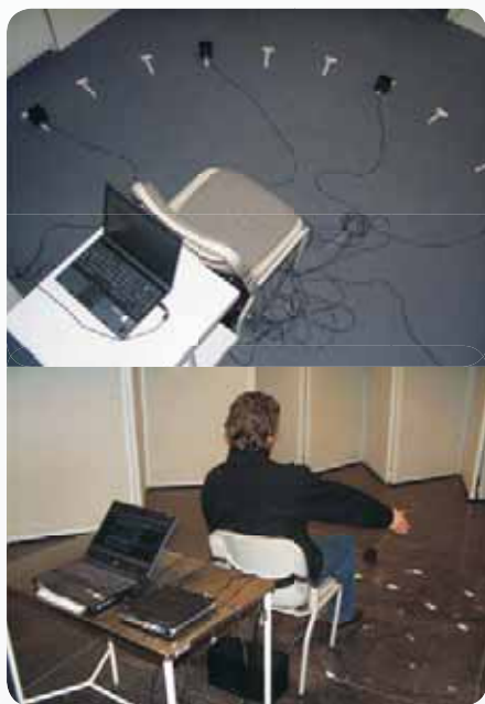
Fot. Stanowisko do badania lokalizacji źródeł dźwięku Photo. Test stand for measuring the localization of sound sources
