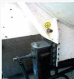
Fot. Przykład umieszczenia punktu uziemiającego i znaku uziemia na pojeździe
