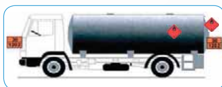
Rys. 4. Oznakowanie pojazdu-cysterny przewożącej jeden rodzaj paliwa, np. UN 1202
