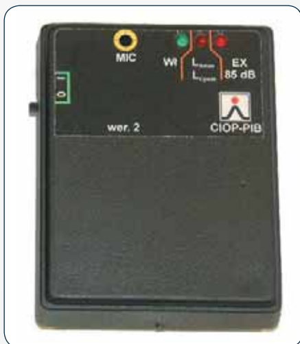
Fot. Wskaźnik dozymetryczny opracowany w CIOP-PIB Photo. Dosimetric indicator researched in CIOP-PIB
