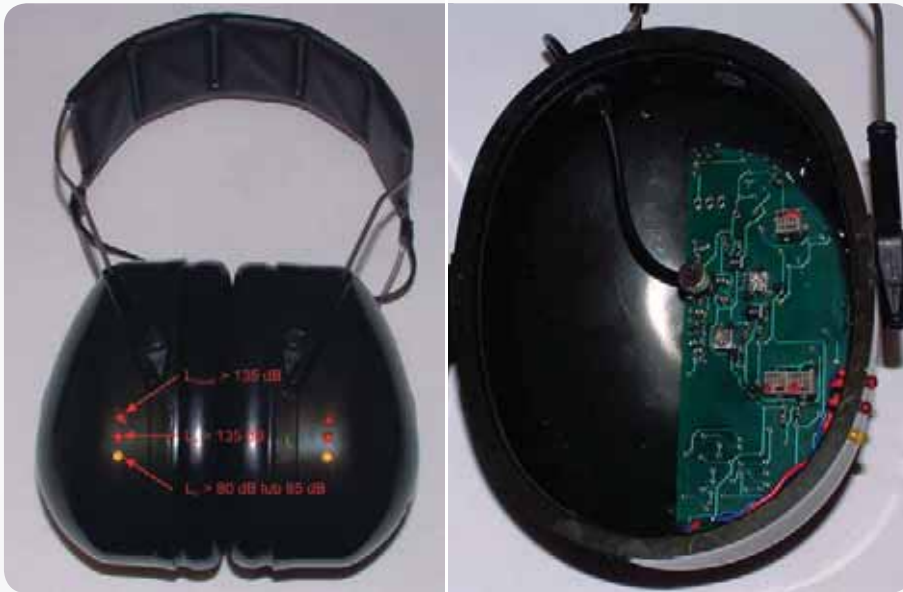
Fot. Model nauszniaka przeciwhałasowego z układem sygnalizującym Photo. Model of an earmuff with an integrated warning device
