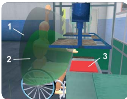
Rys. 2. Komputerowy model osoby niepełnosprawnej poruszającej się na wózku inwalidzkim z widoczną strefą maksymalnego zasięgu rąk (1) oraz przestrzenią pracy rąk (2) podczas analizy możliwości sięgnięcia do obszaru gdzie wykonywana jest praca (3)
