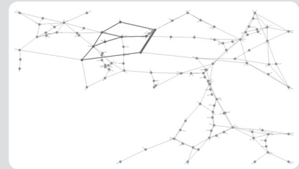
Rys. 5. Usytuowanie grafu cyklicznego w procesie kształtowania się przepływu cyrkulacyjnego – w tym przypadku kilka oczek cyrkulacji mocy P (gałęzie oznaczone czerwonym kolorem, gałąź z PST pogrubiona)
