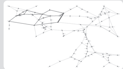
Rys. 7. Rozszerzenie zasięgu grafu cyklicznego na kolejny obszar (kolejne gałęzie) w procesie kształtowania się przepływu cyrkulacyjnego (przekładnia poprzeczna PST osiągnęła ok. 33 st.)
