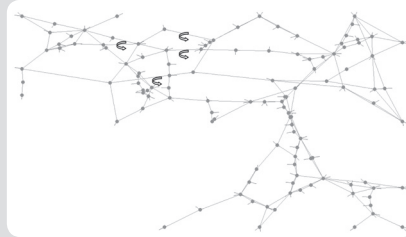
Rys. 3. Zmieniające się na przeciwne zwroty mocy gałęziowych przy zmianach przekładni poprzecznej PST od 0 do 10 stopni w czterech zaznaczonych liniach L45_(B19-B34), L54_(B38-B30), L48_(B33-B37), L18_(B13-B15)
