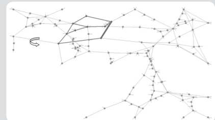
Rys. 6. Usytuowanie kolejnej gałęzi linii L37_(B30-B8), w której przy zwiększaniu przekładni poprzecznej PST o kolejnych 5 stopni – ulega odwróceniu zwrot mocy P
