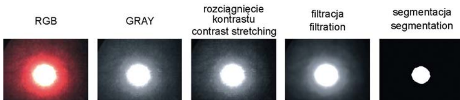
Rys. 12. Wizualizacja poszczególnych etapów cyfrowego przetwarzania obrazu plamki laserowej
