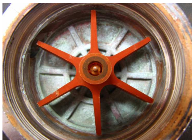
Rys. 1. Wodomierz jednostrumieniowy suchobieżny – komora pomiarowa
