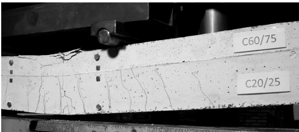
Rys. 7. Dokumentacja zarysowania po zniszczeniu belek zespolonych z warstwą BWW betonu klasy C60/75 – seria Z1
