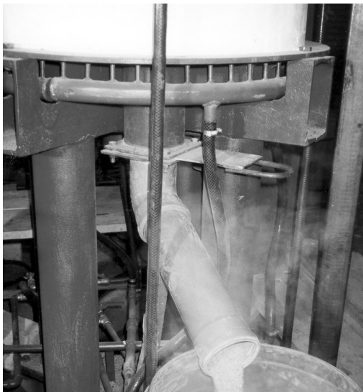
Rys. 2. Widok modelu silosu z instalacją hydrauliczną umożliwiającą chłodzenie ścianki silosu
