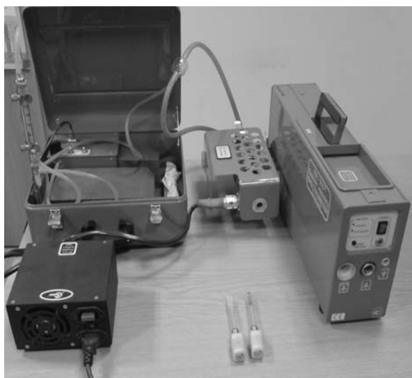
Rys. 2. Spektrometr do oznaczania zawartości rtęci Lumex RA-915+ wraz z przystawką RP-91C
