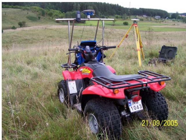
Rys. 2. Pojazd czterokołowy z zamocowanymi odbiornikami geodezyjnymi i nawigacyjnymi Fig. 2. The ATV with assembled equipment used in the experiment
