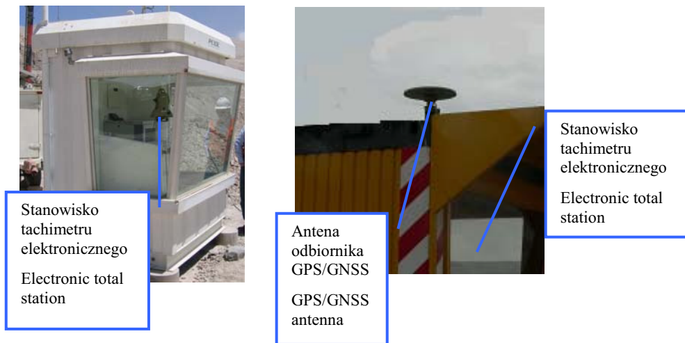
Rys. 6. Widok przykładowego kontenera stacji tachimetrycznej w zadaniach zintegrowanego monitoringu obiektów inżynierskich (źródło: Leica Geosystems)
