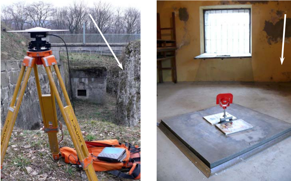
Rys. 10. Wyznaczanie współrzędnych punktu G_KAP za pomocą techniki GPS i pomiarów katowo-liniowych
