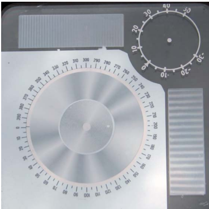
Rys. 3. Odczyt szczelinomierza TM-71 Fig. 3. Reading on the crack gauge TM-71
