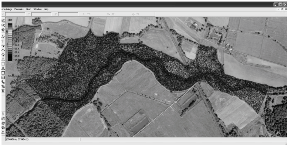
Rys. 2. Siatka dyskretyzacyjna utworzona na podstawie punktów NMT Fig. 2. Discrete mesh based upon DTM points
