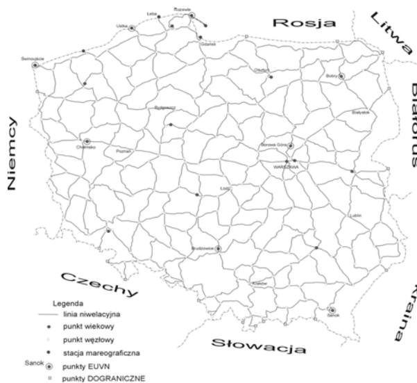
Rys. 8. Sieć niwelacji precyzyjnej I klasy pomierzonej w latach 1997–2003 Fig. 8. First class levelling campaign 1997–2003
