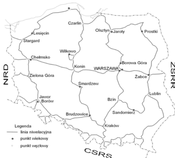
Rys. 4. Sieć niwelacji precyzyjnej I klasy pomierzonej w latach 1953–1955 [Wyrzykowski 1993] Fig. 4. First class leveling campaign 1953–1955
