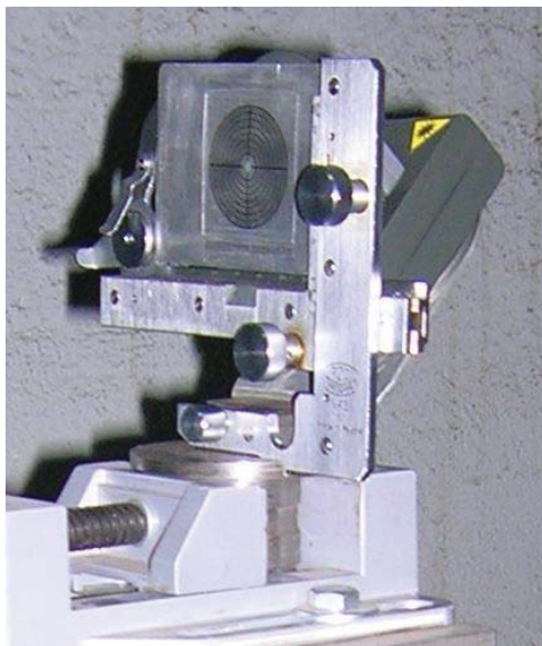
Fot. 1. Widok prototypu tarczy z sygnalizatorem światłowodowym Phot. 1. View of prototype of target with point optical fiber indicator
