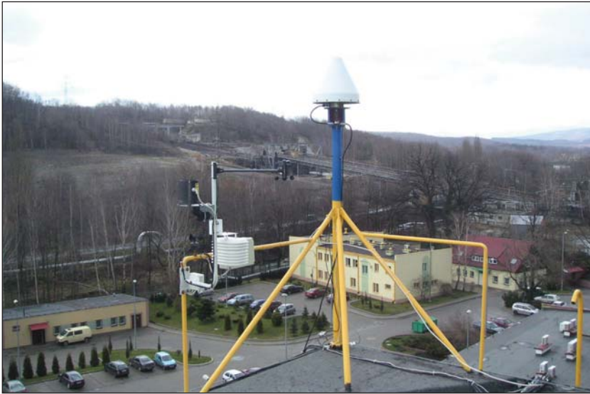
Fot. 2. Antena GPS stacji referencyjnej Phot. 2. The aerial GPS of the reference station
