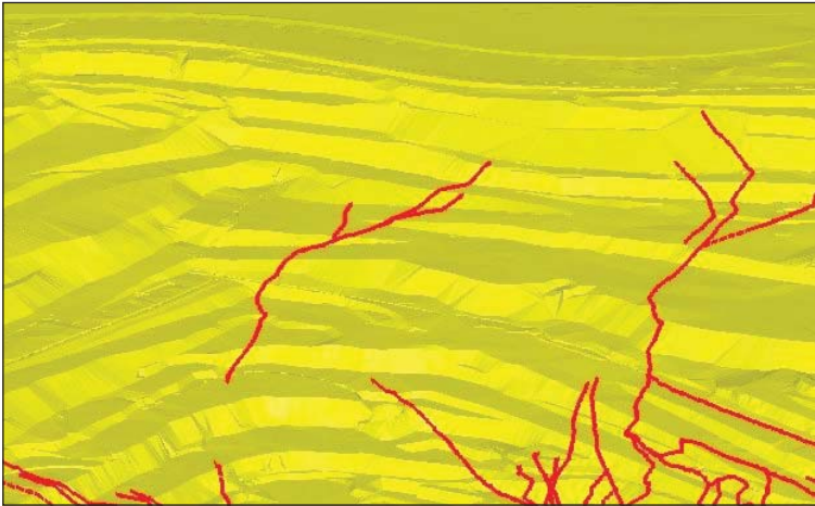
Rys. 3. Numeryczny model terenu ze śladami uskoków tektonicznych Fig. 3. The numerical model of area with marks of tectonical faults
